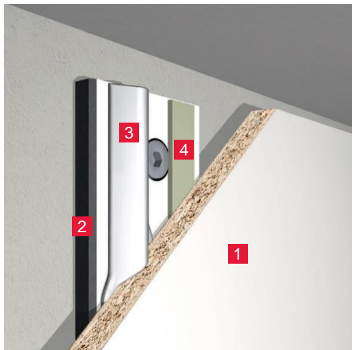
Rysunek 53: Klejenie do konstrukcji nośnej wykonanej z laminatów kompaktowych
