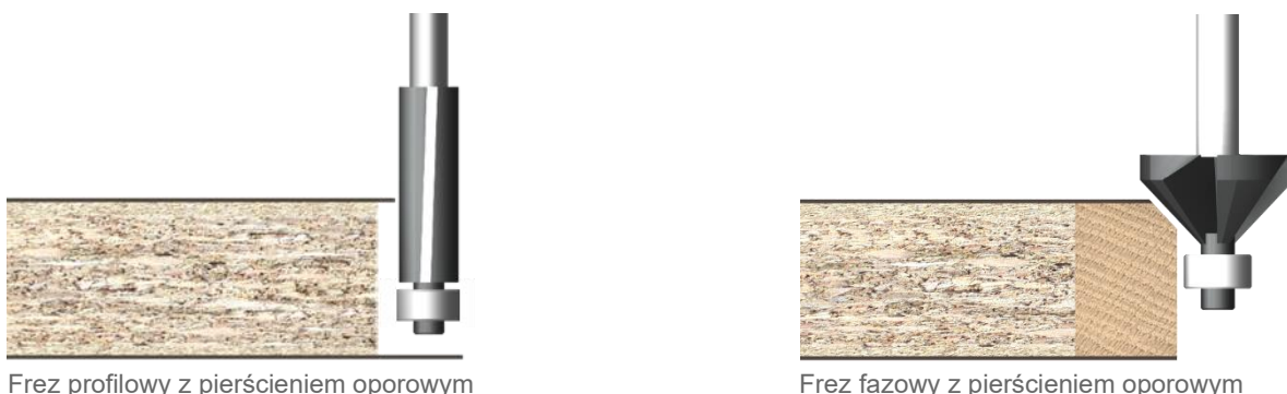
Rysunek 20: Przykłady frezów do urządzeń ręcznych
