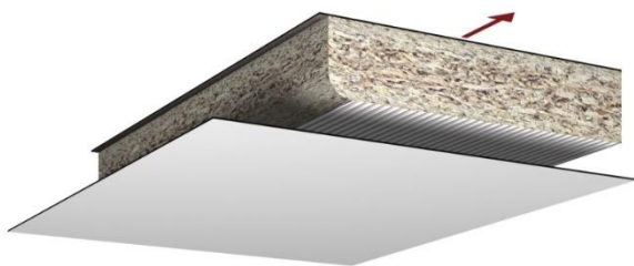
Rysunek 34: Klejenie laminatu do materiału nośnego
