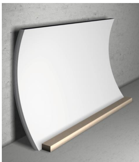
Rysunek 6: Niewłaściwe przechowywanie laminatów
