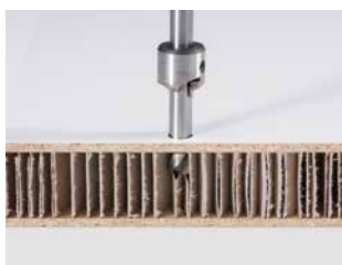
Spezialbohrer und Senker für Kaltschmelzdübel
