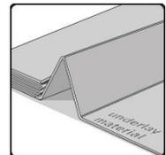
Les sous-couches doivent présenter une épaisseur comprise entre 1,5 et 3,0 mm et une résistance à la pression CS  $\geq$  10 kPa (la valeur recommandée pour des performances optimales est de 60 kPa)
