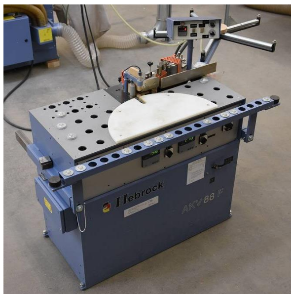
Plaqueuse de chants pour pièces arquées, Hebrock AKV 88 F
