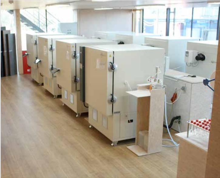
Camere di prova nel "TCLAB", il laboratorio centrale di EGGER a Unterradlberg
