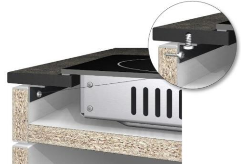
图 51: 使用金属横杆进行加固 Figure 51: Stabilisation with metal traverse
