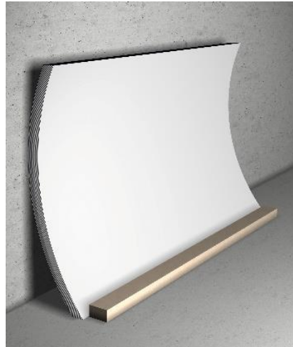
图3：复合防火板不正确的储存方式 Figure 3: Incorrect storage of compact laminates
