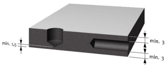
图 5: 转孔距板边的最小边距
