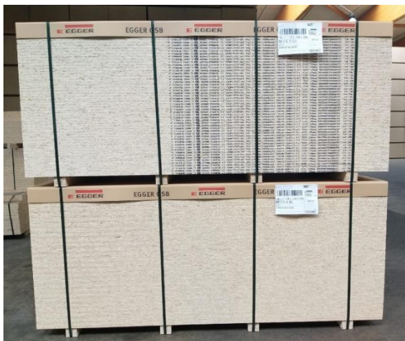
(Immagine 3): esempio di copertura superiore in cartone applicata su pacchi di OSB con bordo dritto
