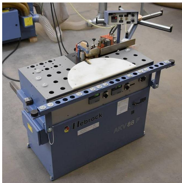
Encoladora para piezas perfiladas con cantos curvados., Hebrock AKV 88 F
