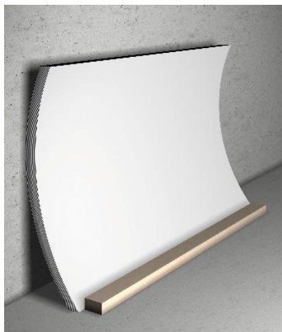
Figure 3 : Stockage non-conforme des stratifiés compacts
