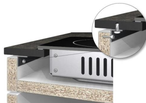
Figure 49: Stabilisation avec traverse métallique
