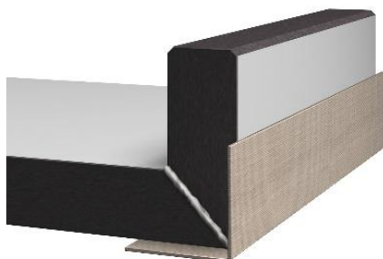
Figure 18: Repliez l'angle et maintenez-le avec du ruban adhésif
