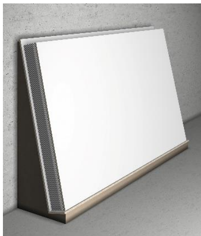
Figure 2 : Stockage conforme des stratifiés compacts
