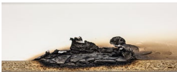
Doorsnede Eurodekor Flammex na 30 minuten van verbranding
