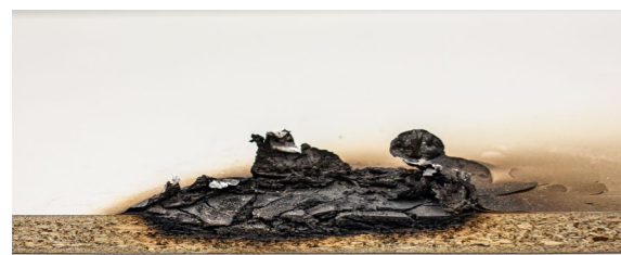
Doorsnede Eurodekor Flammex na 30 minuten van verbranding
