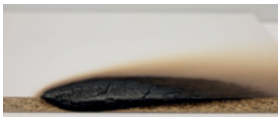
Поперечний переріз Eurodekor після 30 хвилин горіння
