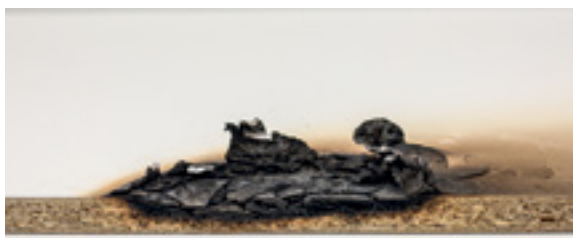
Поперечний переріз Eurodekor Flammex після 30 хвилин горіння
