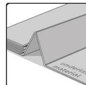
Les sous-couches doivent présenter une épaisseur comprise entre 1,5 et 3,0 mm et une résistance à la pression CS  $\geq$  10 kPa (la valeur recommandée pour des performances optimales est de 60 kPa)
