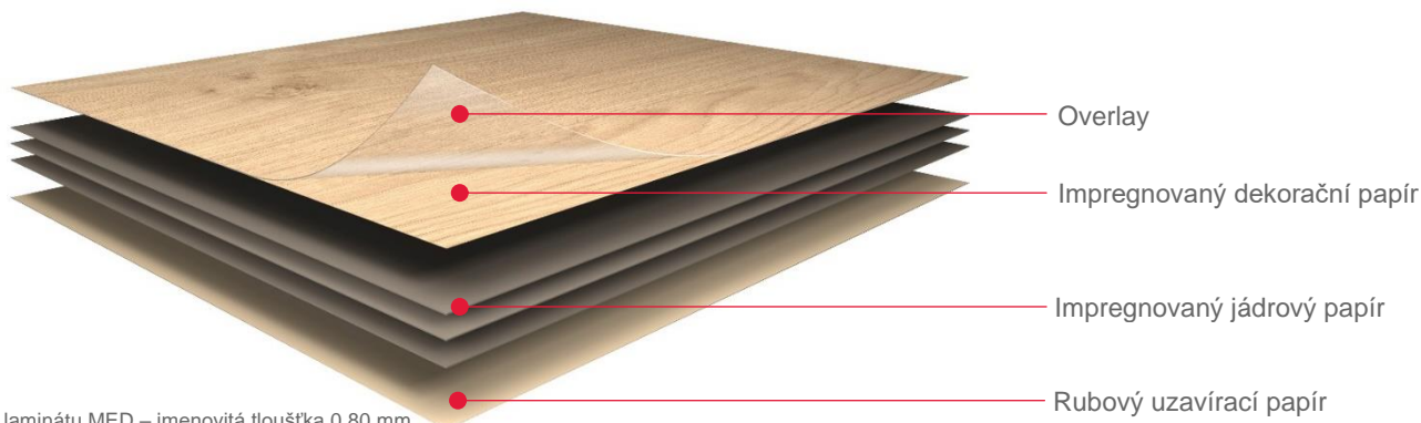
Skladba laminátu MED – jmenovitá tloušťka 0.80 mm
