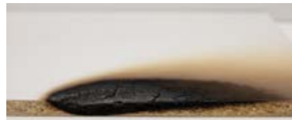
Przekrój płyty Eurodekor po 30 minutach działania płomienia
