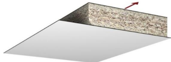
图 35: 防火板突出部分 Figure 35: Laminate projection
