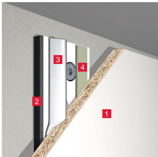
Фигура 53: Залепване към носеща конструкция направена от компактен ламинат
