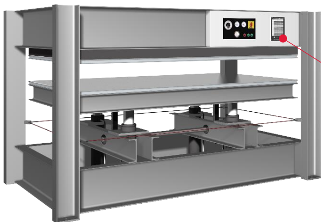
Фигура 15: Преса за фурнир с примерна таблица за налягането според размера на детайла)
