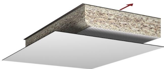
Фигура 34: Залепване на ламината към носещия материал
