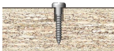
Фигура 19: Завинтване с предварително пробиване
