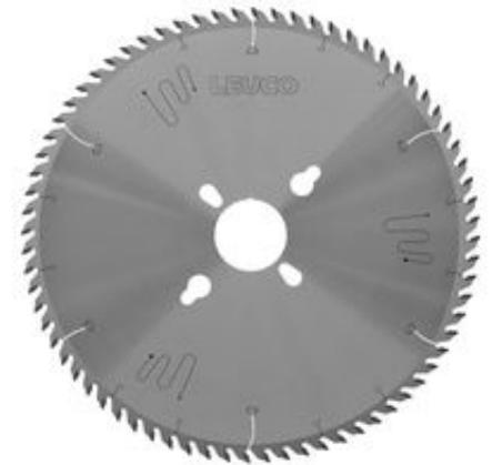
La velocidad de corte recomendada es de 60 - 90 m/seg. Para las sierras circulares con punta DP, se debe seleccionar el valor superior. Se debe apuntar a una alimentación por diente de 0,07 - 0,08 mm.
