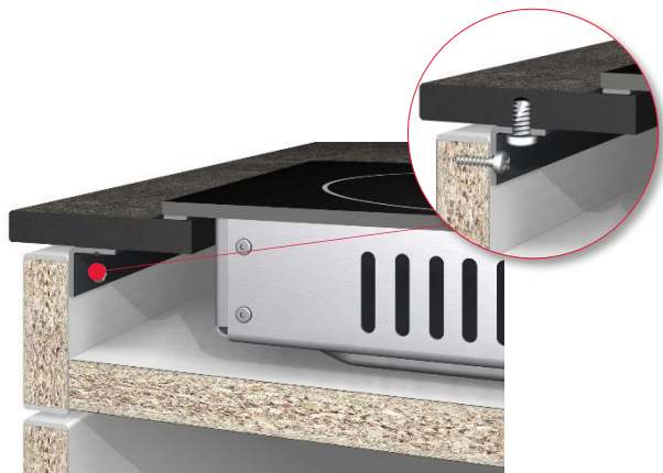
Figura 23: Traverse din metal pentru decupaje
