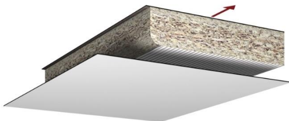
Abbildung 34: Verklebung Schichtstoff mit Trägermaterial
