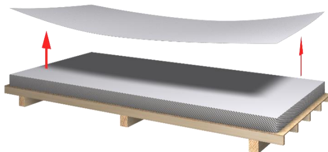
Abbildung 9: Anheben des Schichtstoffs
