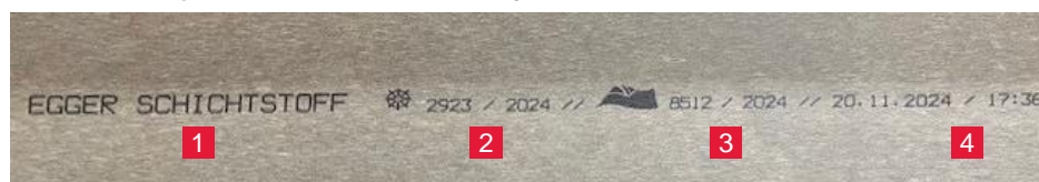
Abbildung 7: Injektionsdruck auf der Schichtstoff-Rückseite
