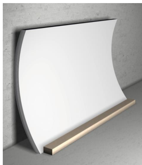
Abbildung 6: falsche Lagerung von Schichtstoffen
