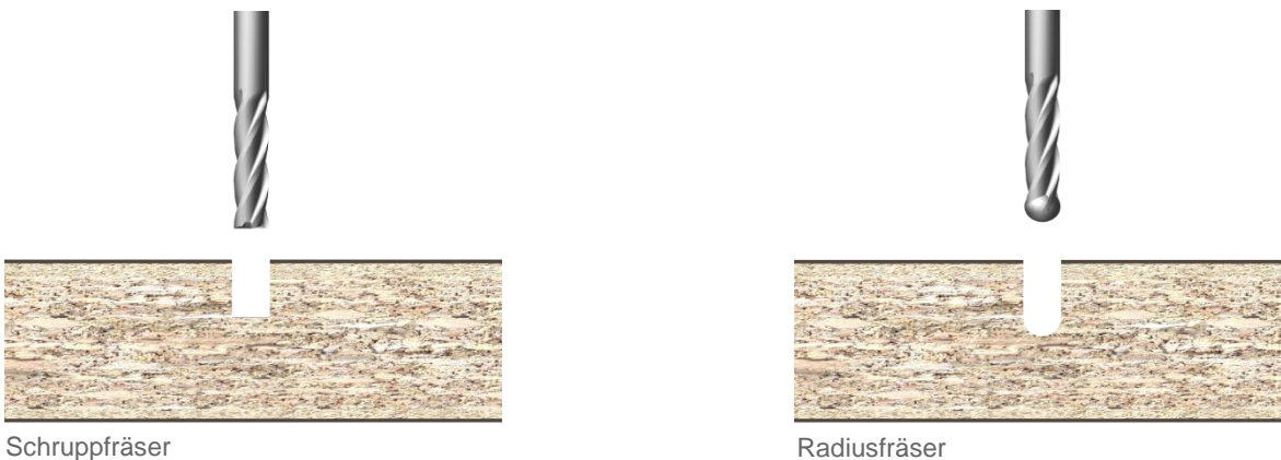
Abbildung 21: Beispiele für Fräsworkzeuge an Holzbearbeitungszentren
