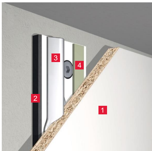
Abbildung 53: Verklebung auf eine Unterkonstruktion aus Kompaktplatte
