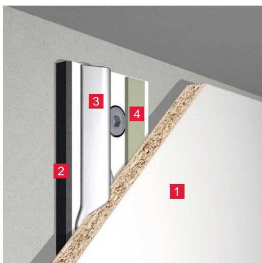
Figura 51 : Colagem sobre uma subestrutura em termolaminado compacto
