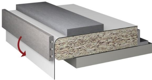
Figura 29 : Pós-formação do termolaminado
