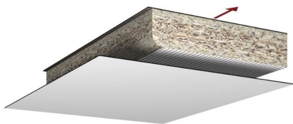
Figura 32 : Colagem do termolaminado no painel de suporte
