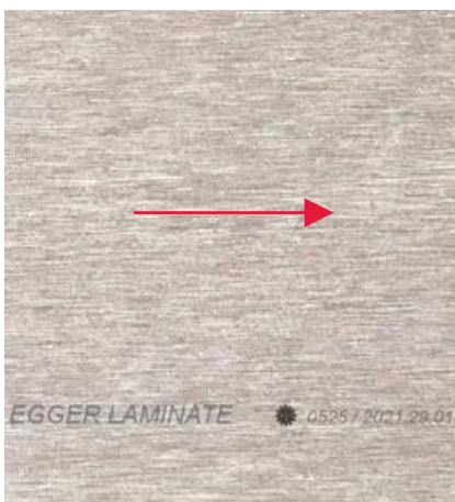
Figura 45 : Sentido de fabricação
