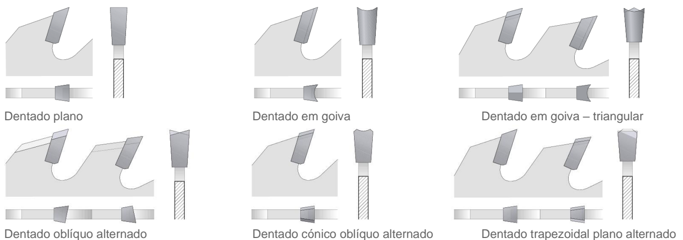
Figura 11 : Exemplos de formas de dentado comuns de lâminas de serra
