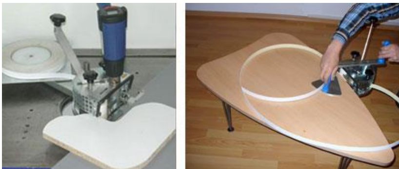
Figura: Encolado con una canteadora «Kantenknirps» www.kantenknirps.de
