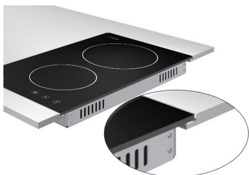
Figura 43: Instalación a nivel
