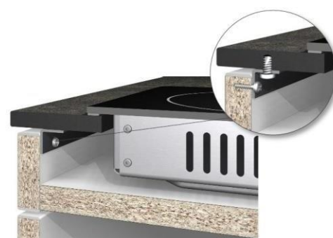
Figura 51: Estabilización con travesaño de metal
