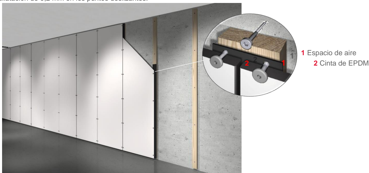
Figura 25: Fijación mecánica visible
