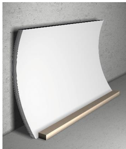
Figura 3: Almacenamiento incorrecto de los laminados compactos
