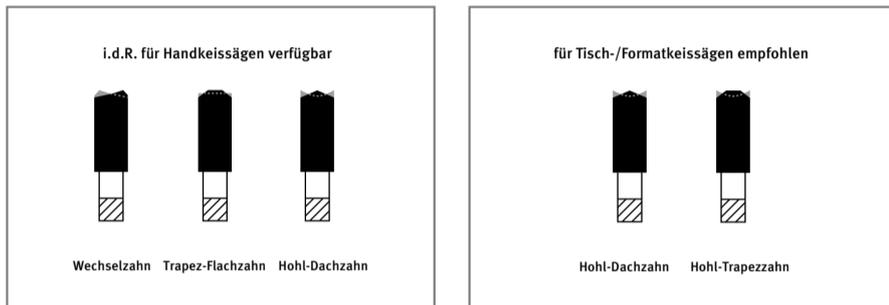
Für das Sägen der DecoWall Platten mit der Handkreissäge werden Sägeblätter mit Trapez-Flachzahn empfohlen. Für Tischkreissägen hingegen Sägeblätter mit Hohl-Dachzahn oder Hohl-Trapezzahn. Je feiner die Zähne sind, desto weniger Ausrisse treten auf. Im Vergleich zum Sägen von Massivholz sollte mit reduzierter Vorschubgeschwindigkeit gesägt werden.
