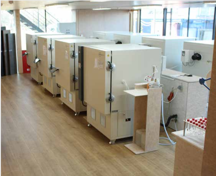
爱格位于奥地利下拉德伯格工厂“TCLAB”实验室中的气候箱试验设备。
