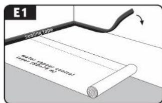
**Atención:** Es absolutamente necesario instalar la lámina de protección específica contra la humedad en toda la superficie y sellarla con una cinta selladora en el área de conexión de la pared en forma de cubeta.
