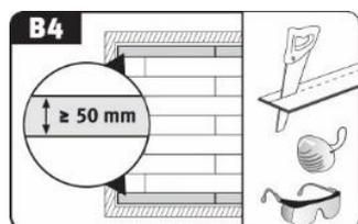
2. Desacople la superficie del piso cortando entre las patas de los muebles y el zócalo
