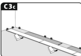
**¡Atención!** Después de fijar los tableros diagonalmente, golpee con un taco de impacto adecuado para asegurarse de que haya encajado bien.
