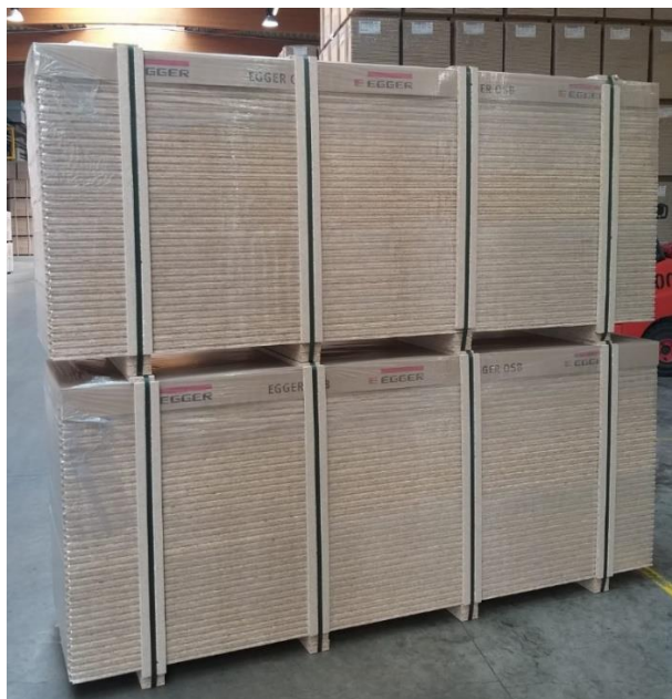
Exemplu: ștraifuri de protecție a canturilor pentru plăcile EGGER OSB cu nut-și-feder (Imaginea 2)
