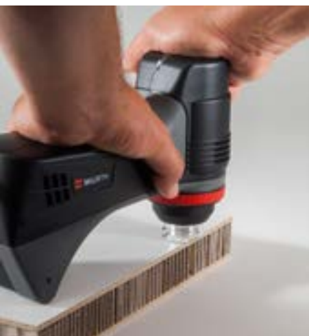
Spezialbohrer und Senker für KALTSCHMELZ®-Dübel
