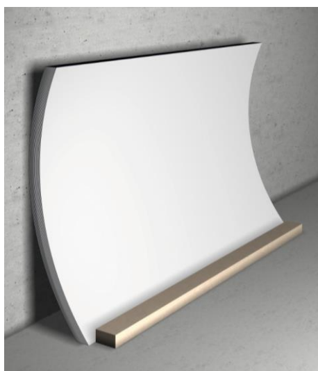
Obrázek 6: Nesprávně uložené lamináty
