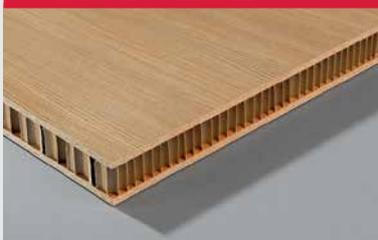
EGGER investiert in ressourcenschonende Technologien und setzt dabei auf Recycling. Statt Holz stabilisiert etwa ein Wabenkern aus Recyclingpapier zwischen dünnen Span- bzw. MDF-Platten die Leichtbauplatte EUROLIGHT.
