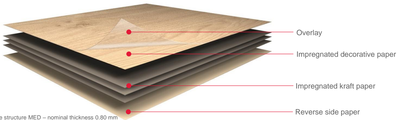
Laminate structure MED – nominal thickness 0.80 mm
