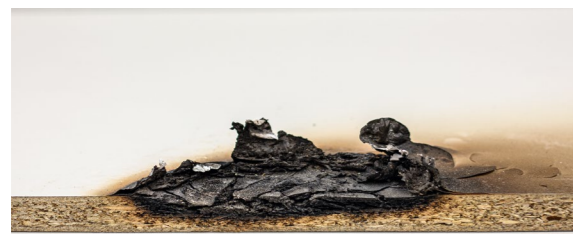
Sezione di Eurodekor Flammex dopo 30 minuti di combustione
