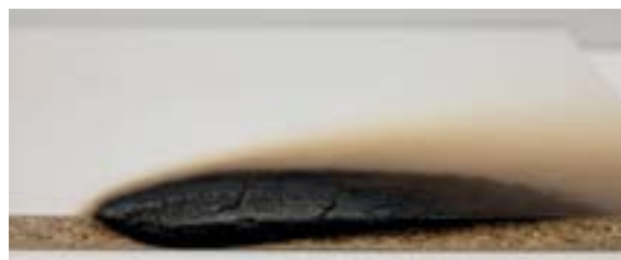
Průřez deskou Eurodekor po 30 minutách hoření
