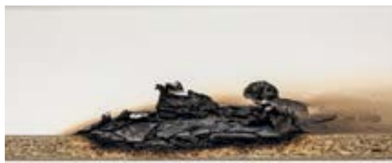
Průřez deskou Eurodekor Flammex po 30 minutách hoření
