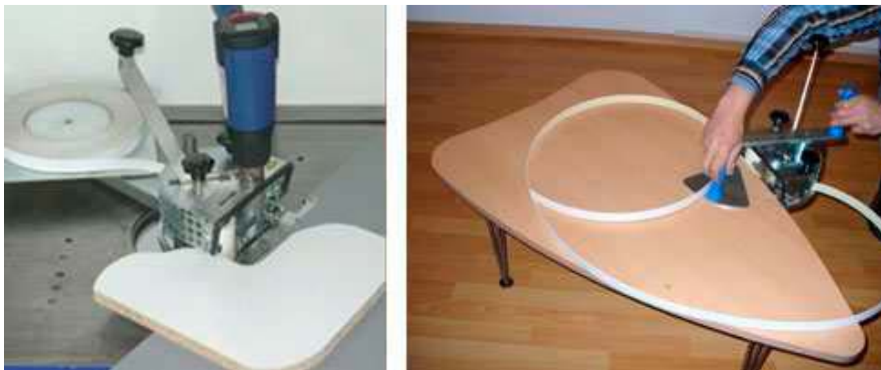
Ilustrare: Utilizarea mașinii de cântuit „Kantenknirps” www.kantenknirps.de
