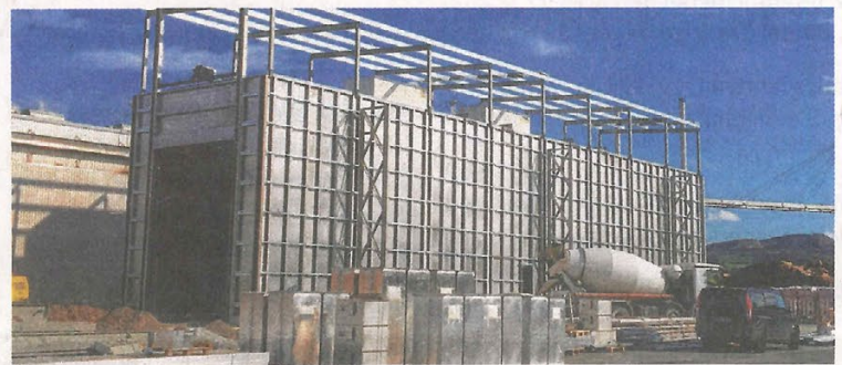
In dem neuen Kanaltrockner des Sägewerks wird dem Schnittholz in einem kontinuierlichen Durchlaufverfahren Feuchtigkeit entzogen.
